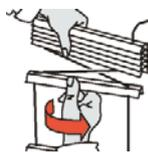
Kletter-Fix: die Faltleiter aus Stahlseil und Alu-Sprossen. Zusammengelegt nach dem einzigartigen Sicherheits-Patentsystem, benötigt die kleinste Rettungsleiter der Welt nur minimalen Stauraum. Dabei sind Kletter-Fix Rettungsleitern wartungsfrei und aufgrund der verwendeten Materialien praktisch unbegrenzt haltbar.
