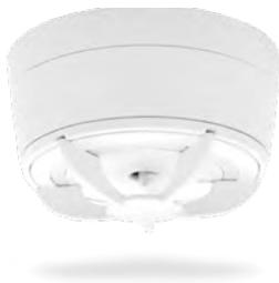
Als Ergänzung zu Funk-Rauchwarnmeldern gem. DIN 14676 in Küchen, Badezimmern und Hobbyräumen, in denen bei einer Installation von Rauchmeldern aufgrund der hohen Dunst- und Rauchbelastung die Gefahr von Fehlalarmen besteht. Alarmierung bei 58 °C oder bei schnellem Temperaturanstieg. Inkl. 3V-Lithium-Batterie für 5 Jahre störungsfreien Betrieb (auswechselbar).
