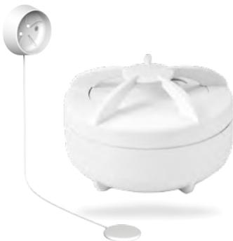
Funk-Wassermelder zur Alarmierung bei Wasserschäden durch Hoch- oder Leitungswasser. Ein spezieller Montagesockel mit einer Sonde, die auf den Boden gelegt wird, ermöglicht die Wandmontage des Melders (Zubehör). Inkl. 3V-Lithium-Batterie für 5 Jahre störungsfreien Betrieb (auswechselbar).
