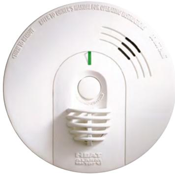
Firex 230V-Wärmemelder alarmieren bei Temperaturen ab 58 °C (und nicht bei Rauch). Daher eignen sich diese Geräte insbesondere als Ergänzung in Räumen mit hoher Luftfeuchtigkeit oder Staubeentwicklung (Küche, Bad, Werkstatt, etc.).
