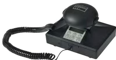
Durch das Alarmsignal eines Rauchwarnmelders werden ein Vibrationskissen sowie eine Stroboskopleuchte aktiviert, um Gehörlose und hörgeschädigte Menschen im Brandfall zu warnen. Batteriebetrieben und universell einsetzbar.
